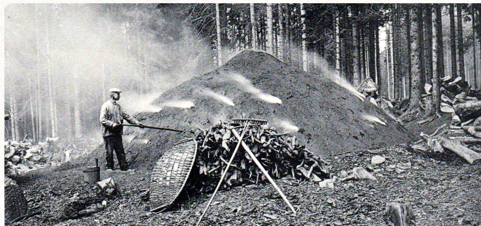
V okolí této zastávky lze najít místa, kde se vyrábělo dřevěné uhlí pálením dřeva v milířích (foto z doby kolem roku 1910). Auch in der Nähe dieser Station kann man Orte finden, an denen durch das Verkohlen von Holz in Meilern Holzkohle hergestellt wurde (Foto um 1910).
