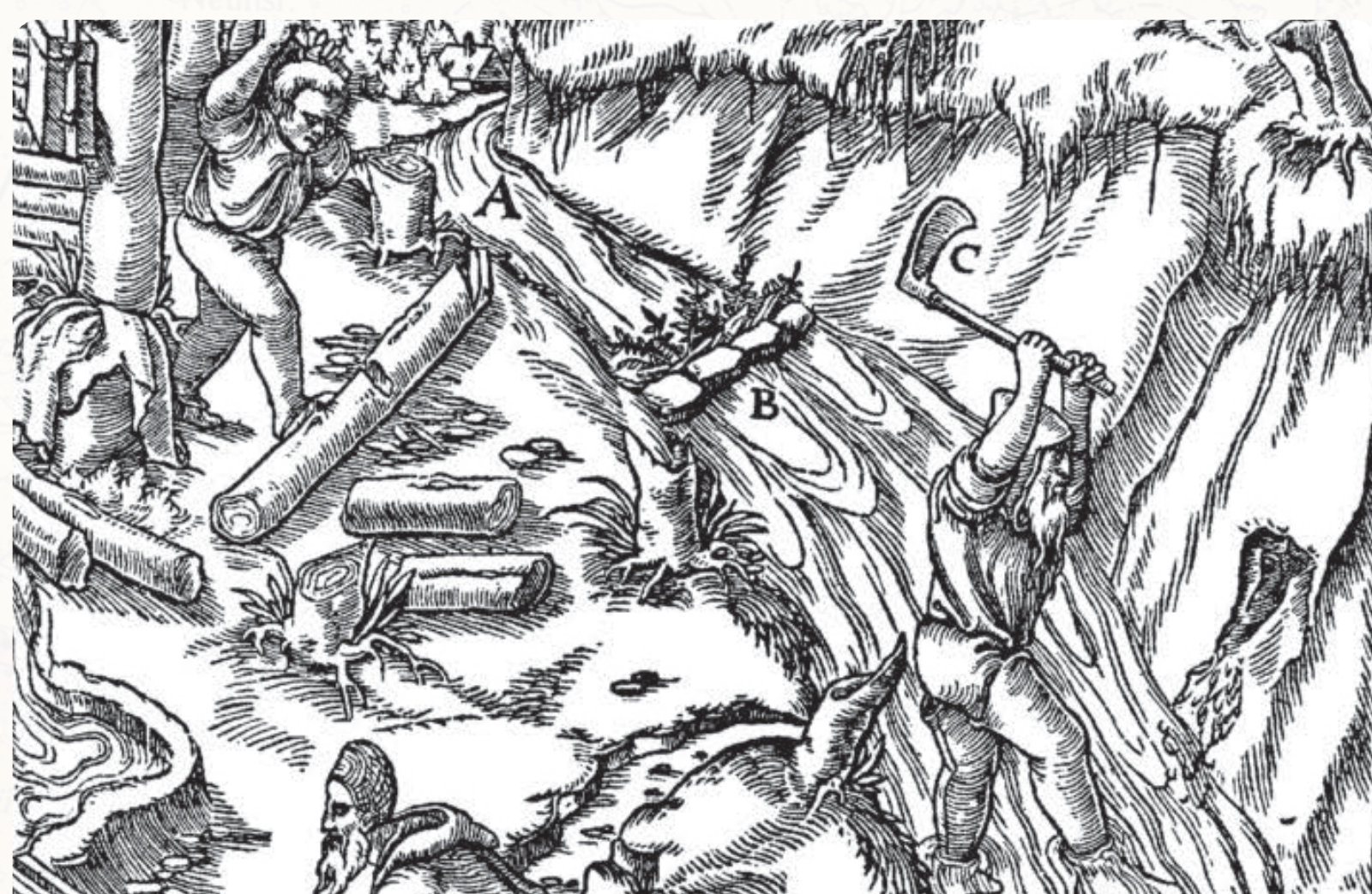
Sedimenty bohaté cínovcem byly pomocí motky a krumpáče strhávány do vodních toků, jež byly na více místech přehrazeny pomocí kamenů a drnů (Agricola 1556). Zinnreiche Sedimente wurden mit der Hacke und Keilhaue in die Wasserläufe niedergelassen, die an mehreren Stellen mit Steinen und Rasen verdämmt wurden (Agricola 1556).
