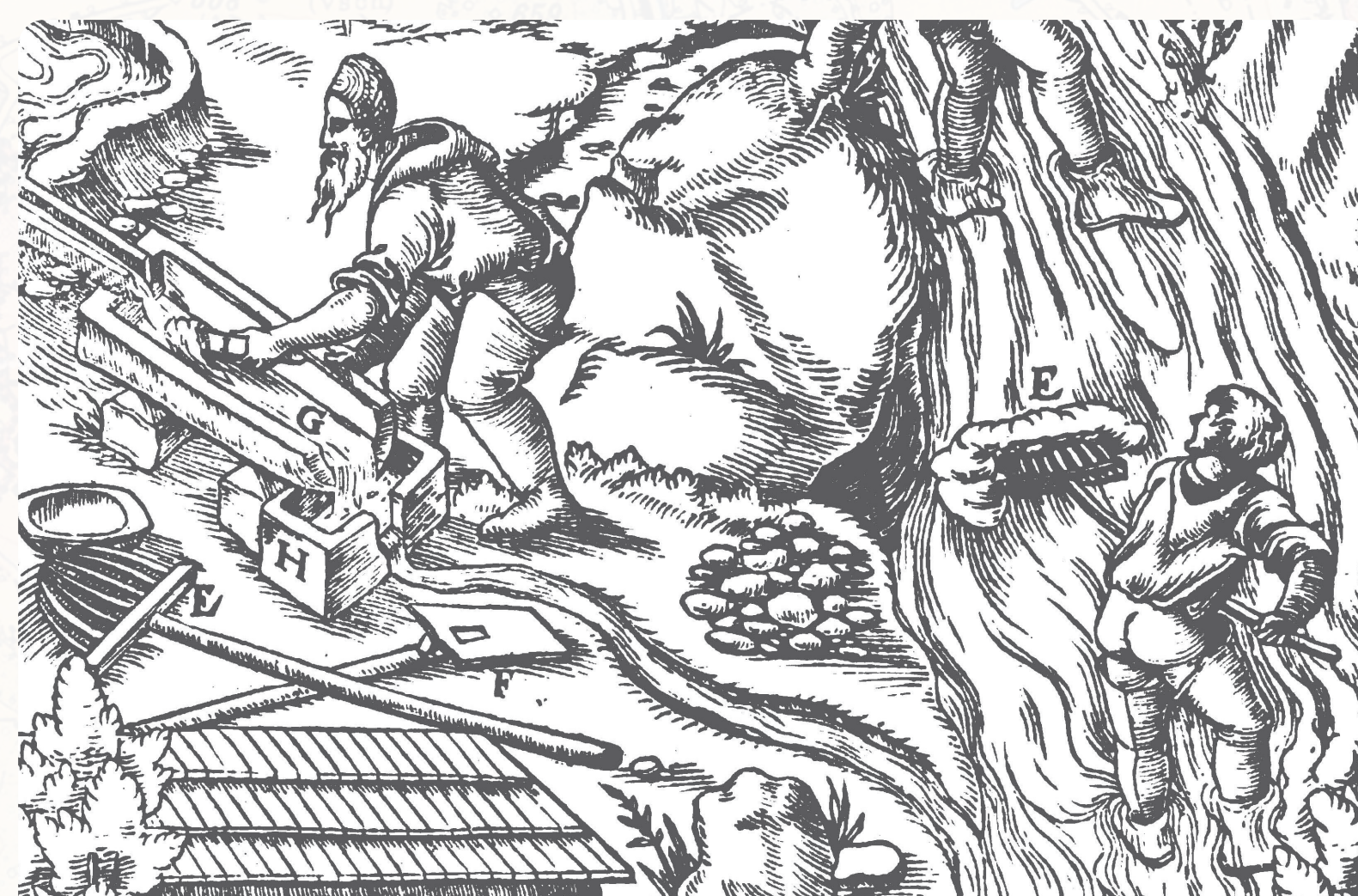
K odstraňování nečistot a prohazování materiálů používali rýžovníci speciální hrábě (Agricola 1556). Spezielle Seifengabel, die von den Seifnern verwendet wurde, um Schmutz zu entfernen und größere Stücke herauszuscheidern (Agricola 1556).
