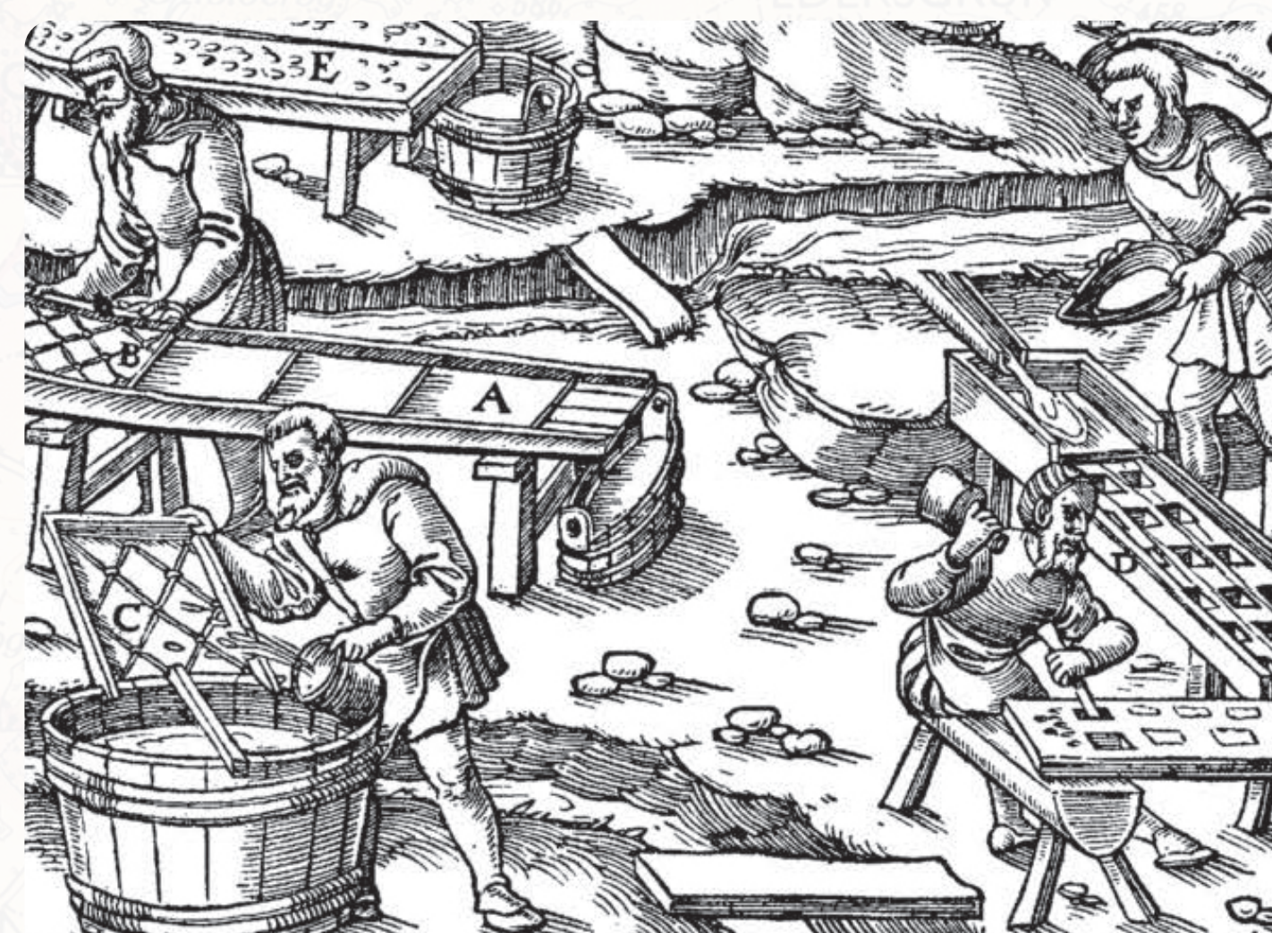
Různé typy splavů používaných k oddělování těžkých minerálů (cínovce, zlata aj.) od lehčí hlusiny (Agricola 1556). Verschiedene Arten von Herden, die zur Trennung schwerer Mineralien (Zinnstein, Gold usw.) von leichteren Rückständen verwendet wurden (Agricola 1556).
