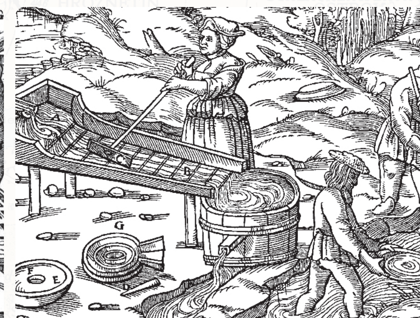
Práci na splavech zajišťovaly i ženy, vpravo muž s rýžovníckou miskou (Agricola 1556). Die Arbeiten an den Stoßherden wurden von Frauen ausgeführt, rechts ein Mann mit einer Zinnwaschplanne (Agricola 1556).
